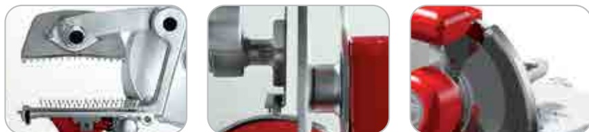
Braço especial com prendedor BS2 Amplo espaço entre a lâmina e a base do equipamento. Proteção da lâmina removível
