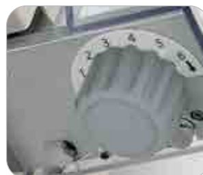
Regulagem precisa da espessura de ambos conjuntos de rolos
